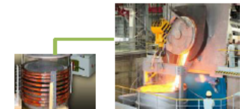
【誘導加熱式】※電気を使用する
